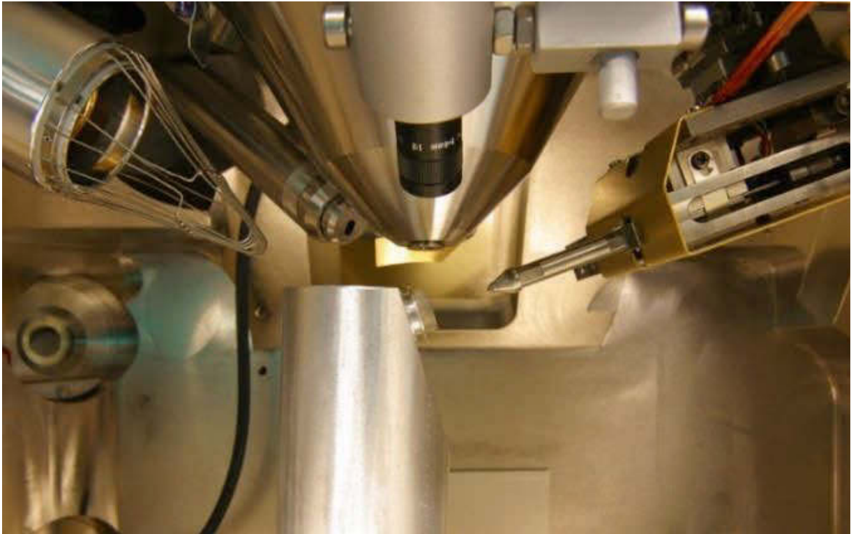
Bild 4.3: Unser mikromechanisches in-situ-Testsystem, das in ein Rasterelektronenmikroskop integriert ist. Fig. 4.3: Our micromechanical in-situ test rig integrated into a scanning electron microscope.
